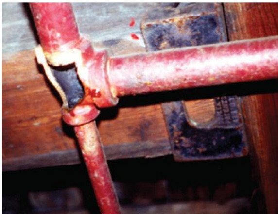
Egy éjszakára nyitva hagyott ajtó miatt elfagyott vízvezeték lyukadásának következménye [10]
